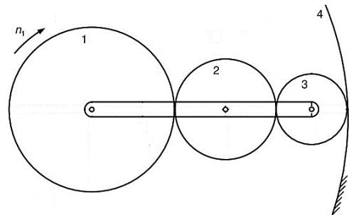
Se a engrenagem 1 está acoplada ao eixo de um motor que rotação a 750 rpm no sentido horário, qual a rotação do eixo de saída no braço se a engrenagem 4 é fixa?
