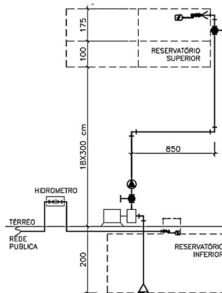
A tubulação compreendida entre o orifício de saída da bomba e o ponto de descarga no reservatório superior é a de:
